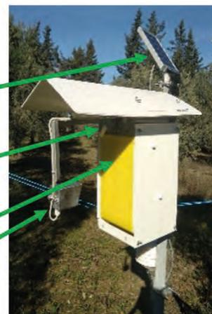
Figure 2 : Piège vertical TrapView
